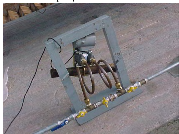
Figura 3 - Instalações para a medida de vazão usando o método de Gibson
